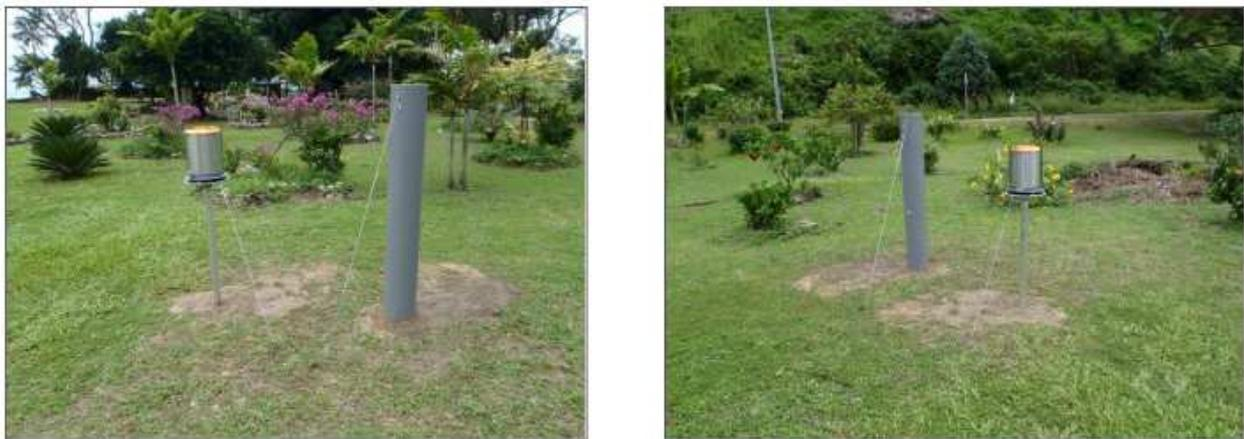
**Figure 13 : Pluviomètres aval, vue amont et aval (source : EMR)**
