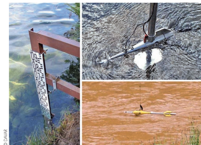
Échelle et support de sonde limnigraphique, courantomètre à hélice monté sur saumon et micro-moulinet, dispositif de jaugeages de hautes eaux
