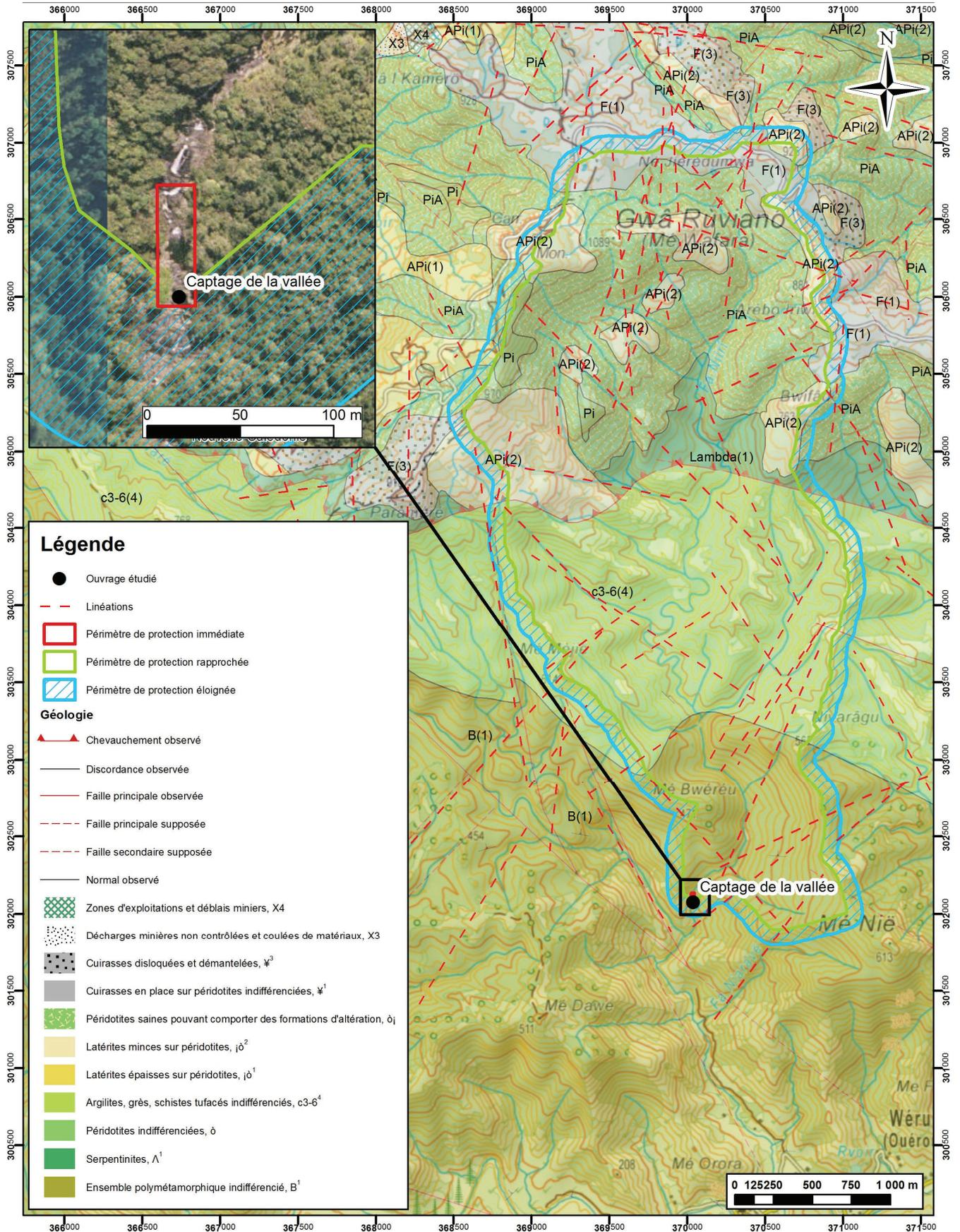
Figure 2 : Périmètres de protection immédiate, rapprochée et éloignée du captage
