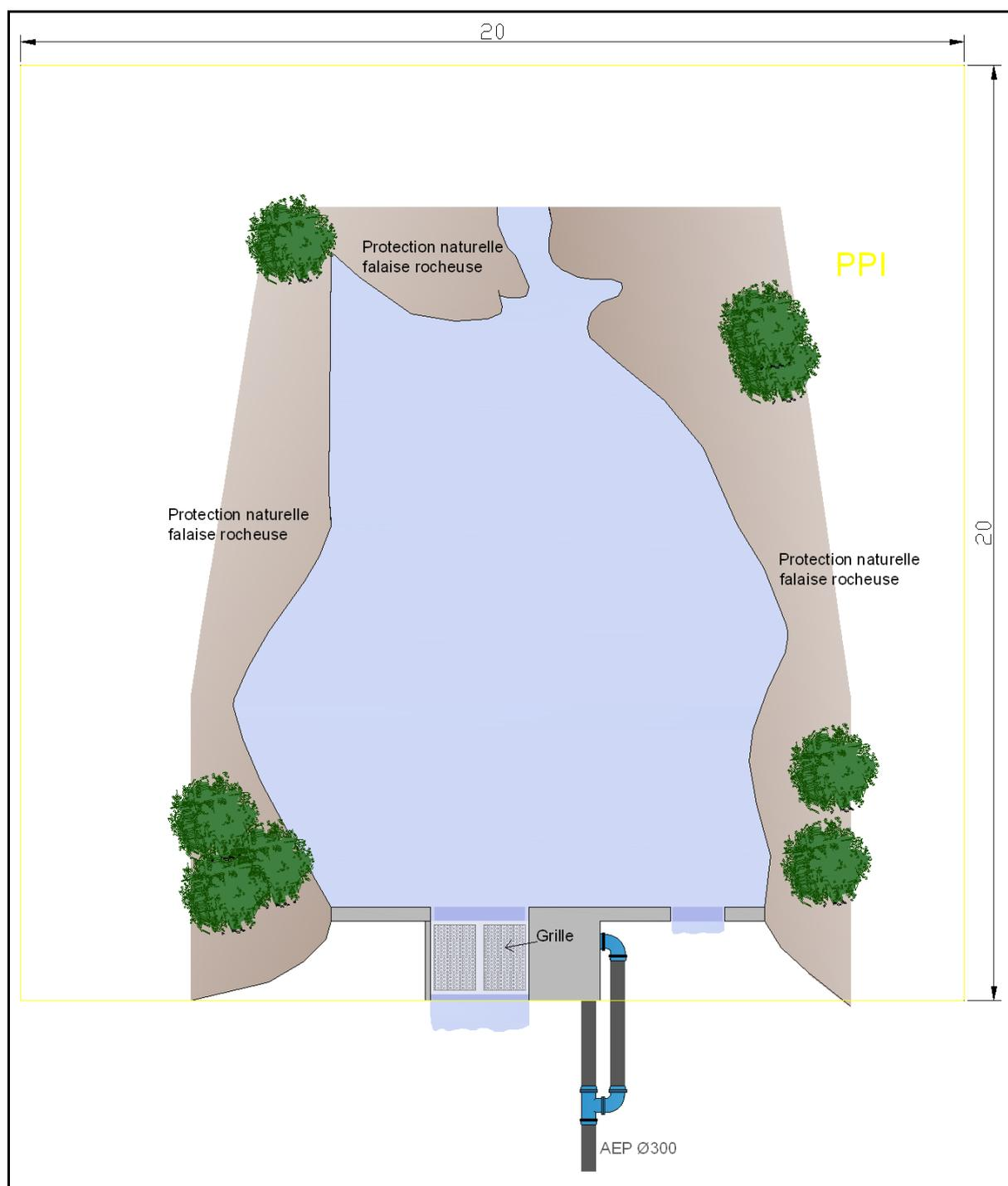
Figure 5 : Délimitation du périmètre de protection immédiate du captage d'Ema (cotes en mètres)
