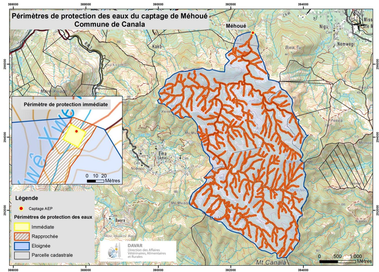
Figure 3 : Périmètres de protection des eaux proposés pour le captage de Méhoué sur fond IGN
