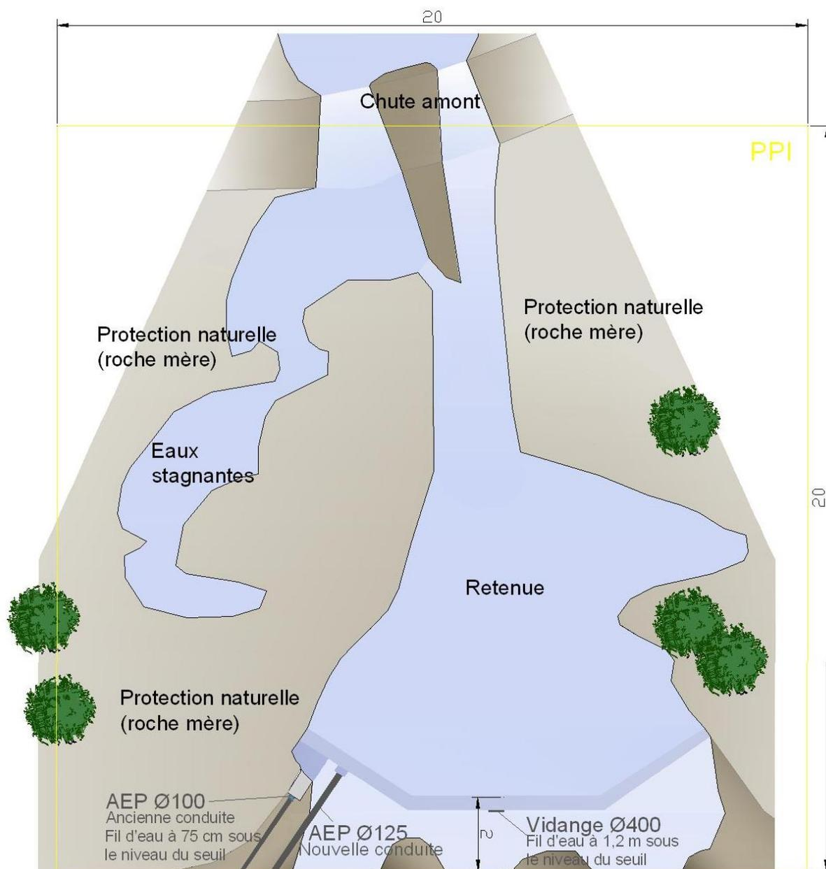
Figure 5 : Délimitation du périmètre de protection immédiate du captage de Méhoué (cotes en mètres)
