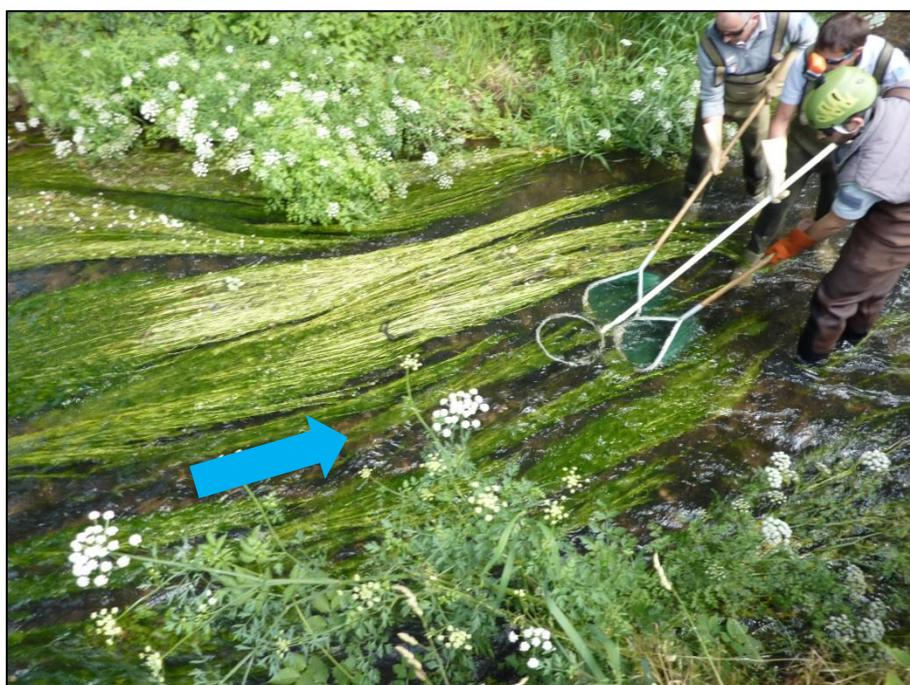
**Figure 1** Action de pêche en radier : l'électrode ramène les poissons de l'amont vers les épuisettes (photo T. Vigneron - AFB)
