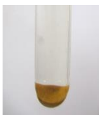
Figure 9 : Culot rouge obtenu après traitement d'un échantillon riche en latérite.
