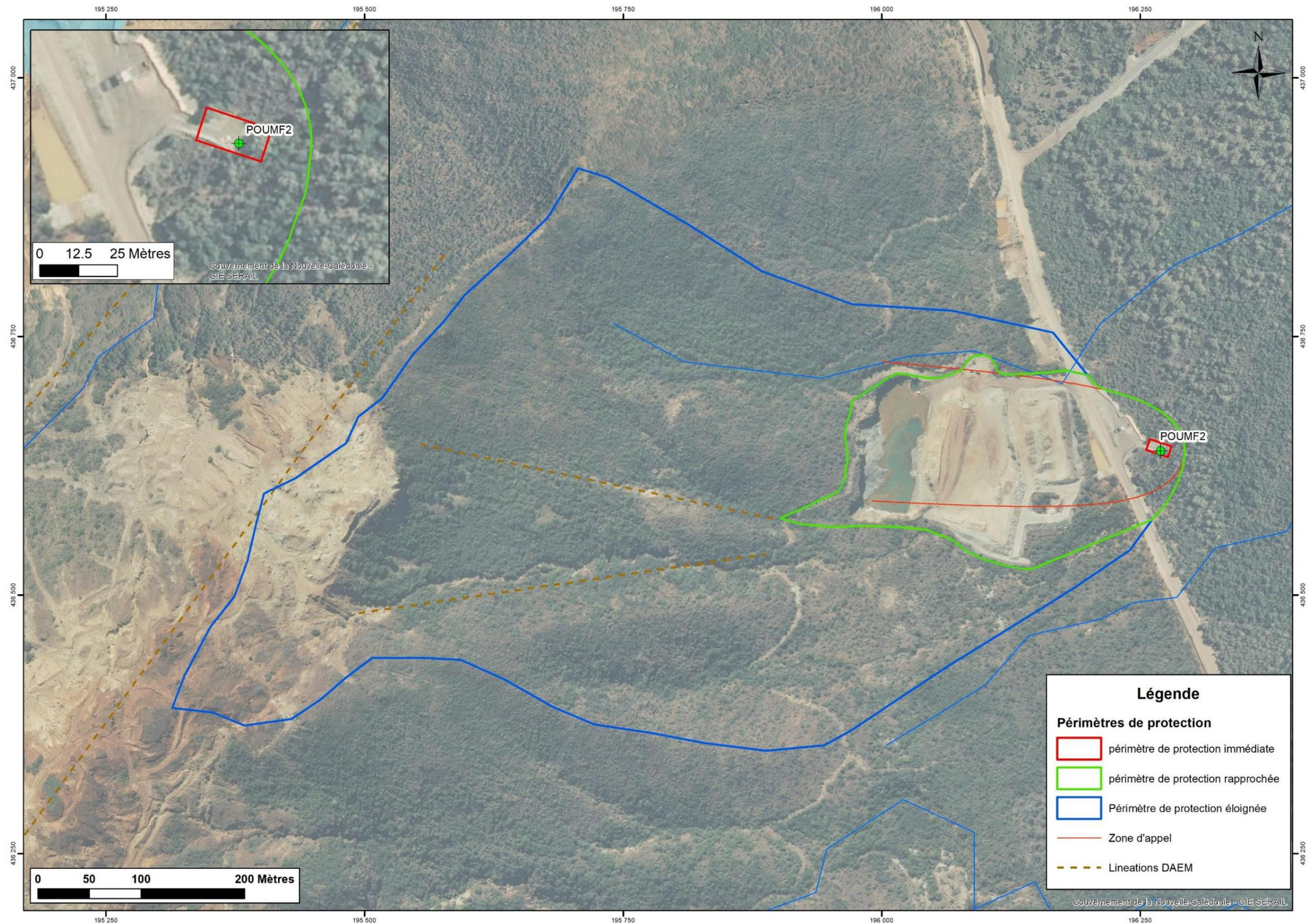
Figure 2 : Localisation des périmètres de protection sur le forage POUF2 (C9)
