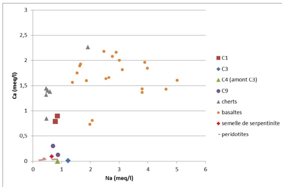
**Figure 15 : Diagramme Ca/Na des eaux de forages du massif de Poum, graphe et données SGNC**
