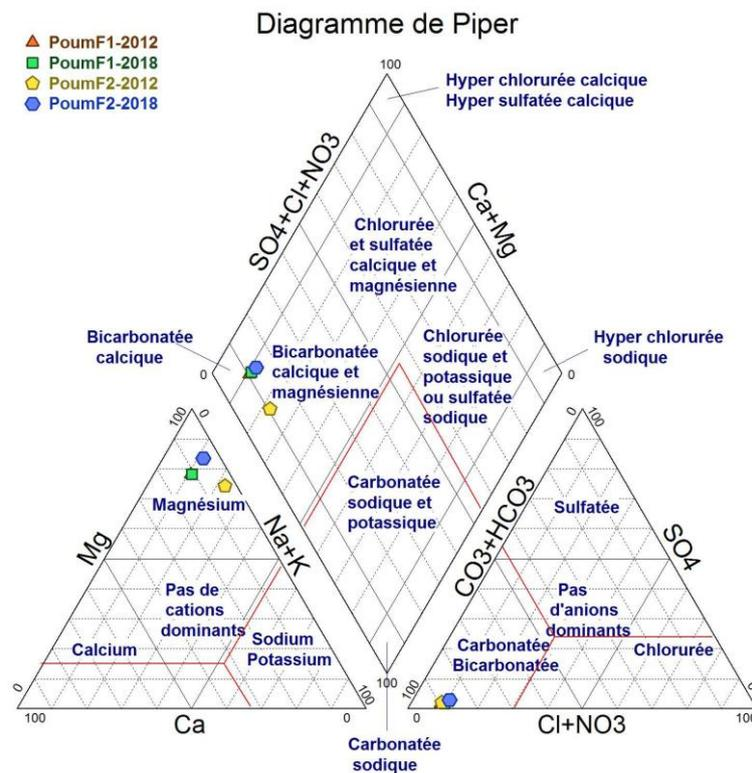
**Figure 14 : Diagramme de Piper - faciès des eaux captées par les ouvrages de l'étude**
