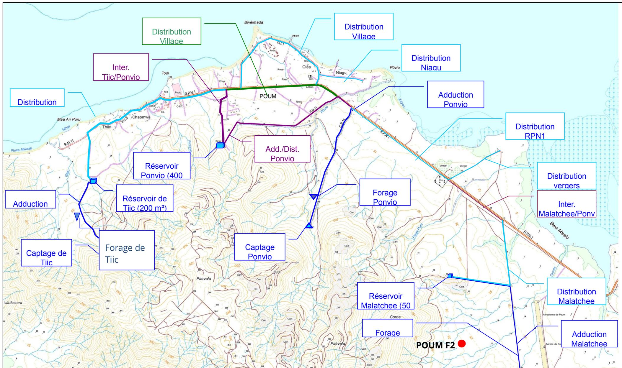
Figure 4 : Schéma du réseau AEP Village-Tiic-Ponvio-Malac de la commune de Poum
