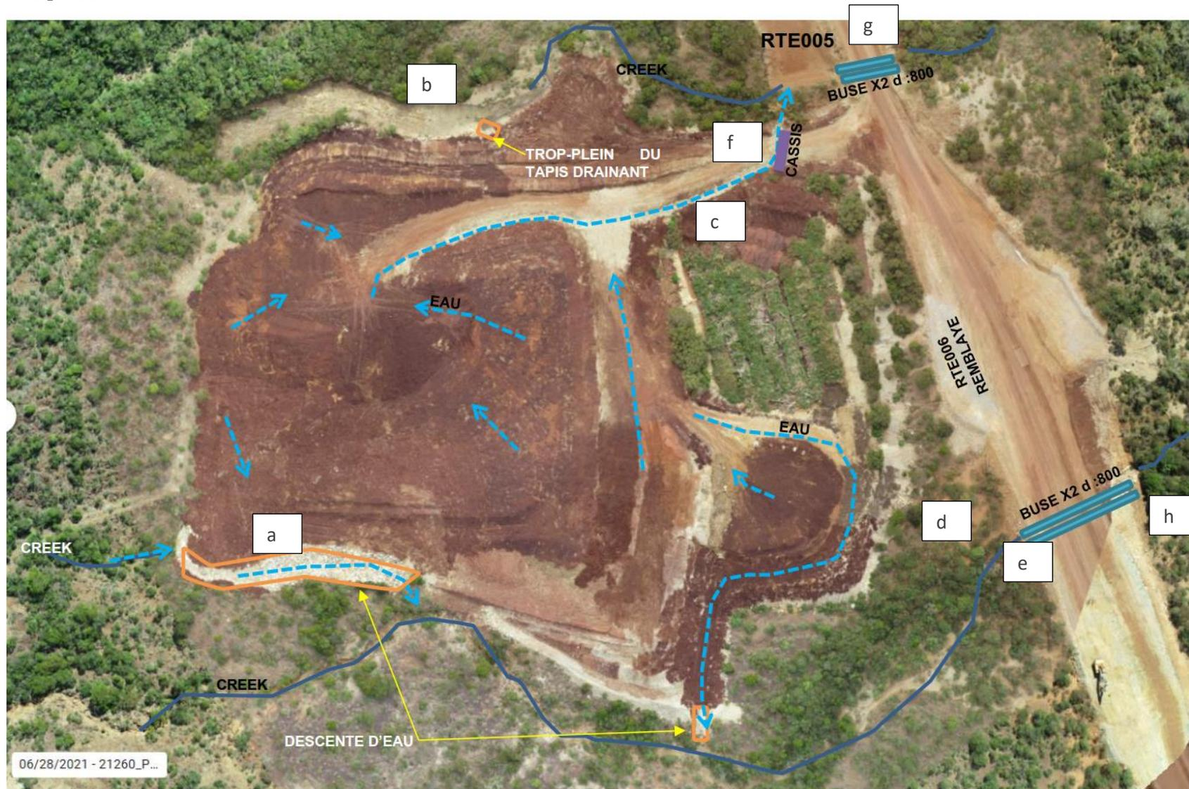
**Figure 10 : Plan de gestion des eaux dans la zone de PoupF2, suite aux travaux de comblement de la carrière en eau en amont du forage PoupF2 (Note de fin de travaux comblement su trou d'eau, SLN, Juillet 2021)**
